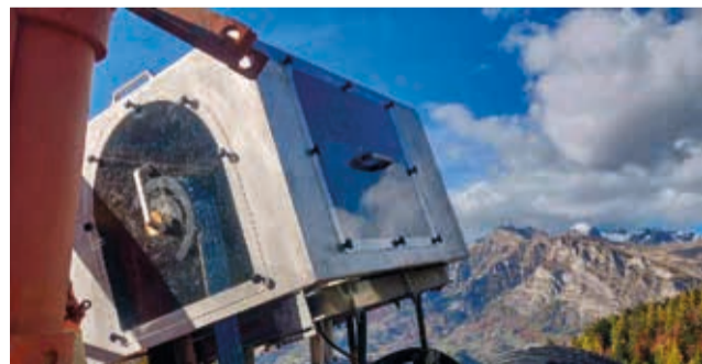
Groupe hydraulique remplacé par un moteur électrique capoté.
