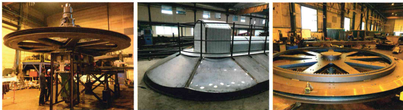
Montage à blanc de la gare, de la couverture de protection, et de la poulie et sa couronne dentée.
