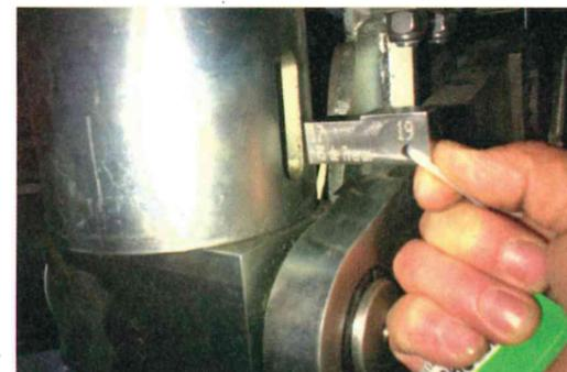
Jauge de contrôle mini/maxi. la cote H ne doit jamais être inférieure à la cote mini.
